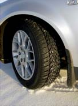
Lamellenprofile gewährleisten sicheren Antrieb
